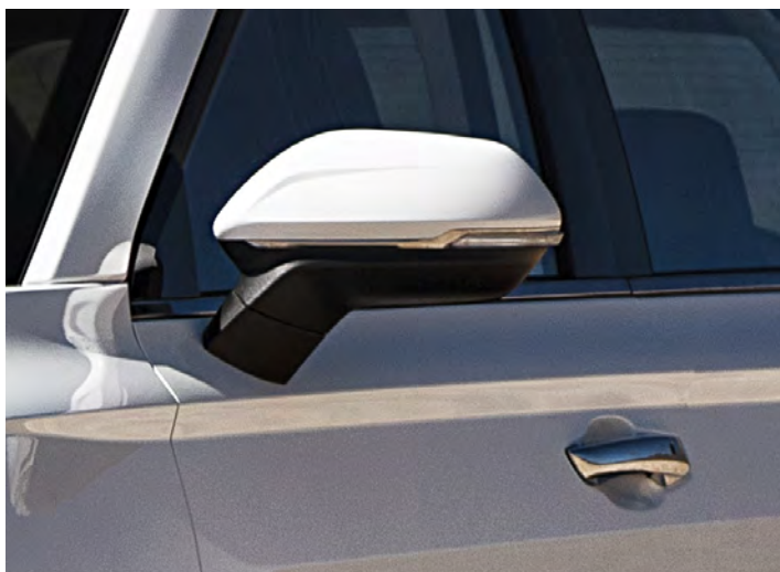
Espejos laterales con luz de dirección (con efecto flujo secuencial)
